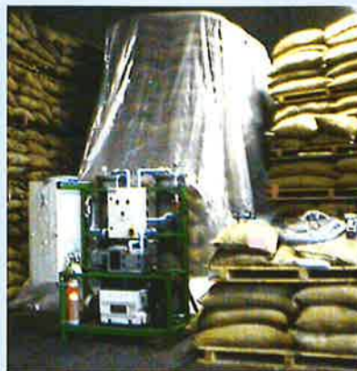
4.) Exemplo para tratamentos de desinfestação em massa: aplicação de uma tecnologia nova: gerador de nitrogênio que retira o oxigênio do ar atmosférico através de colunas de peneira.
