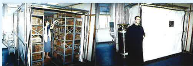
2.) Exemplo de um tratamento de anóxia de média a grande escala do acervo de livros raros do Mosteiro de São Bento, Rio de Janeiro numa câmara especial de fumigação de 16 m 3 que veda hermeticamente a gás, mediante um zíper do tipo zip-lock triplo. Para este tratamento se utiliza gás nitrogênio que está sendo injetado e umidificado através de uma unidade controladora microprocessada desenvolvida especialmente para este tipo de aplicação (inérito no Brasil) - para volumes de até 30 m 3 .
