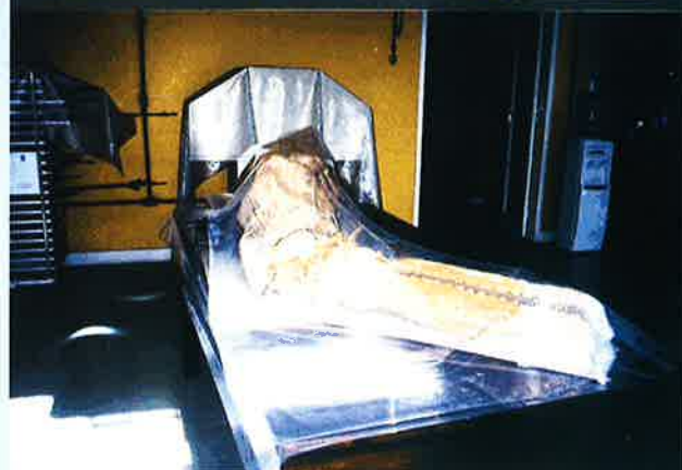
A máscara na fase do purgo com nitrogênio com um analisador de oxigênio para verificação no nível ppm da concentração de oxigênio.
